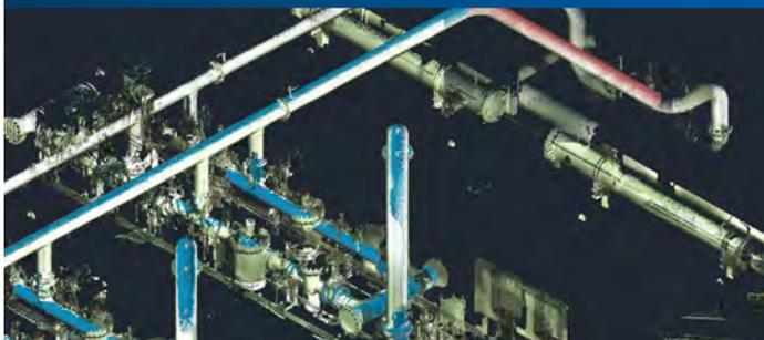
Generieren Sie bei Bedarf genaue Bestandsdaten für die Planung von Gebäuden und Nachrüstungsprojekten. Mit präziseren und umfassenderen Daten können Sie sicherstellen, dass der Entwurf funktioniert. Sie können den Entwurf auch validieren, indem Sie das virtuelle Overlay mit den Bestandsdaten des Standorts vergleichen, um Abstandsprüfungen und Kollisionserkennung durchzuführen.
