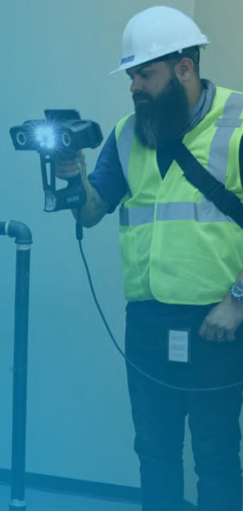
Der FARO Freestyle 2 Handgeführter Scanner ist ein leichtes und mobiles Modell, das sich perfekt für komplexe Bauprojekte eignet. Er kann allein oder in Verbindung mit einem FARO Focus Laser Scanner verwendet werden. Da es sich um ein Handgerät handelt, können Sie sich leicht auf der Baustelle bewegen, um komplizierte Details in engen oder unübersichtlichen Bereichen, die sonst schwer zu erreichen wären, genau zu dokumentieren.
